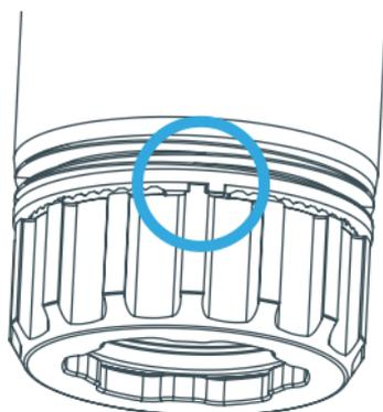
2. Drücken Sie die Rastplatte gegen die Feder und drehen Sie die Mutter über den Anschlag. Dazu kann ein flacher Schraubendreher verwendet werden. Jetzt kann die Mutter eine weitere Umdrehung gelöst werden. Wiederholen Sie diesen Schritt, bis die Mutter entfernt werden kann.
